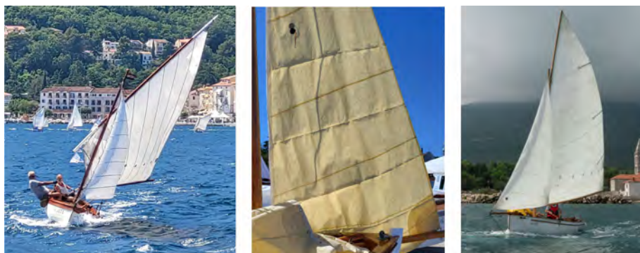
Slika 7. Položaj krojki – vertikalne i horizontalne krojke (ferše)
