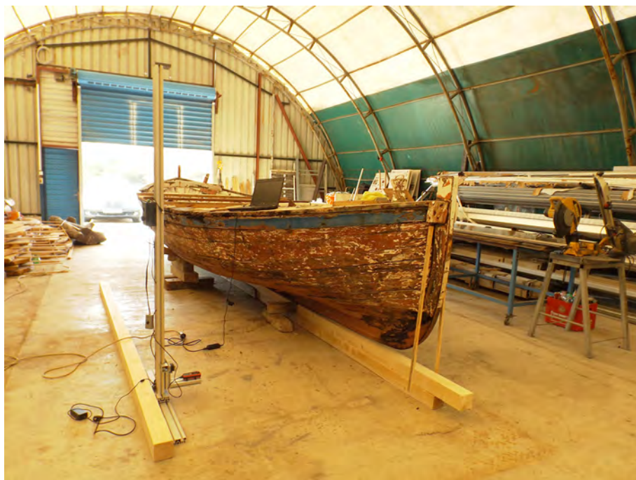
Slika 1. Skeniranje gajete Jaglica 2D skenerom Udruge Palagruza Izvor: Udruga Palagruza
